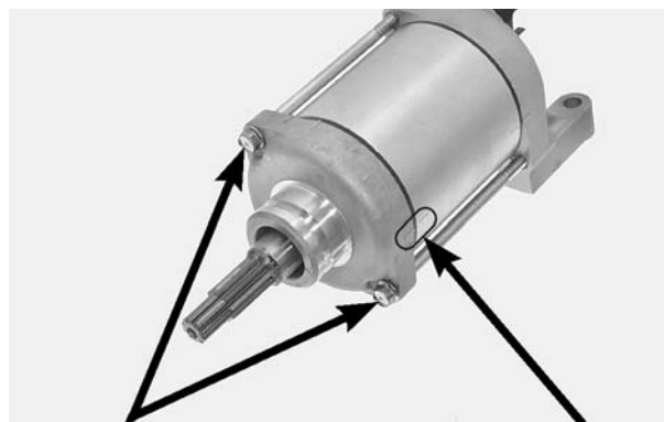
PARAFUSOS ANEL DE VEDAÇÃO
