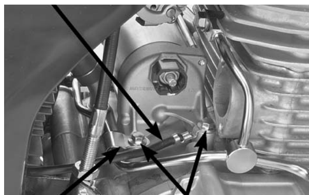
SUPORE DO DUTO PARAFUSOS CABO DO MOTOR DE PARTIDA CAPA DE BORRACHA
