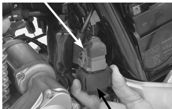
CABOS INTERRUPTOR DO RELÉ DE PARTIDA CAPA DE BORRACHA
